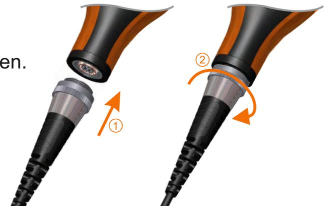
Um eine Beschädigung der Sondenspitze im Scan- oder Wiederholautomatikmodus zu vermeiden, muss eine Sondenkappe angebracht werden. Wenn während der Kalibrierung nach Aufforderung durch das Messgerät keine Kappe verwendet wird, schaltet das Messgerät automatisch in den Standardmessmodus um.
