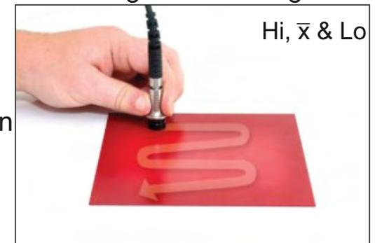
*Wiederholautomatik:* Wenn die Sonde bei Verwendung der Wiederholautomatik auf die beschichtete Fläche aufgesetzt wird, erfasst sie automatisch automatisch 140 Messwerte pro Minute, bis sie wieder von der Fläche abgehoben wird. Jeder einzelne Messwert wird im Speicher abgelegt. Die Wiederholautomatik kann eine erheblich schnellere Inspektion großer beschichteter Flächen wie zum Beispiel Stahlträger, Tanks, Schiffsrümpfe usw. bewirken.
