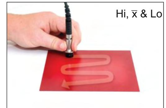
*Modo de Auto Repetición:* Cuando la sonda se coloca sobre el sustrato revestido en el modo de repetición automática, el medidor toma lecturas automáticamente a una velocidad de 140 por minuto hasta que la sonda se retira del sustrato. Cada lectura individual se almacena en la memoria. El modo de repetición automática se puede utilizar para acelerar significativamente el control de grandes áreas revestidas como vigas de acero I- (RSJ), tanques, cascos de barcos, etc.
