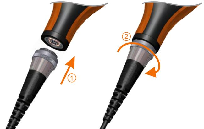
为避免“扫描”或“自动重复”模式下探头触点的损坏，需要套好探头保护套。校准过程中，仪器会提示套好保护套，若不进行这一操作，仪器会自动转入“标准”测量模式。
